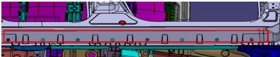
图 6-6 裙边防石击涂料喷涂平面区域示意图
